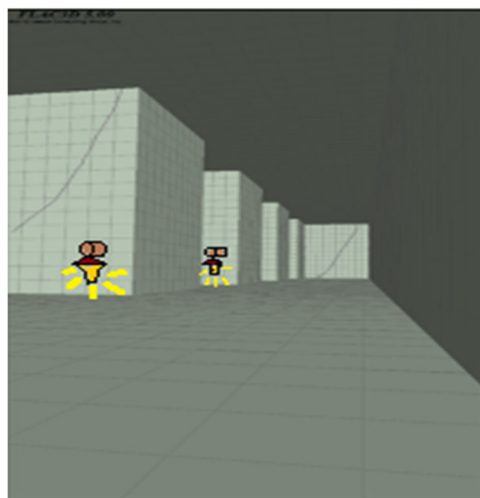
図-14 場合2の例：(対策2.3)鉄筋の頭をきれいな形に装飾して、灯りをつける
