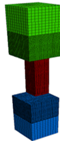
図-2 残柱モデルの3D差分メッシュ
