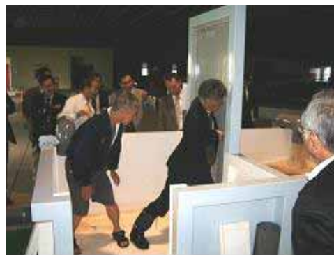
浸水時のドア開閉体験実験の様子 （京大防災研）
